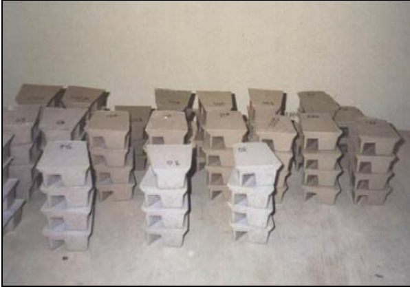
Şekil 6. Değişik numaralarda hazırlanan granat içerikli sentetik silim taşları
