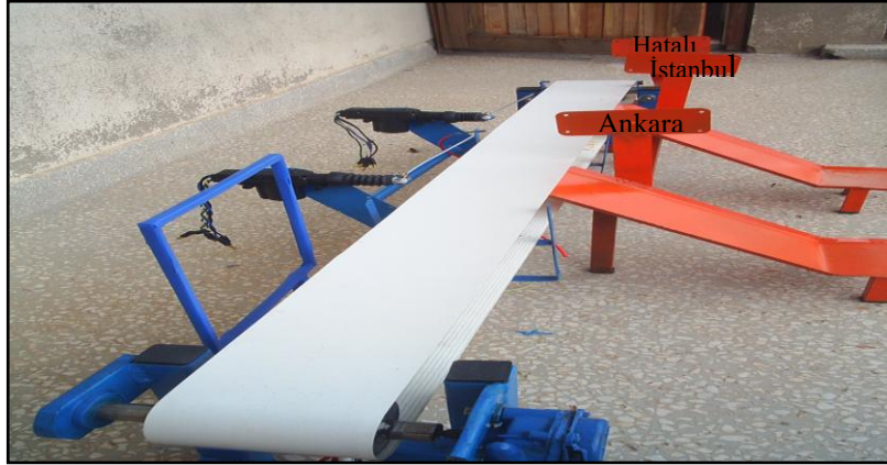
Şekil 5. Yürüyen Band ve Otomatik Ayırma Düzeneği
