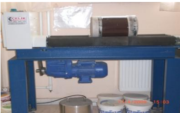
Şekil 2. Laboratuvar ölçekli öğütme ünitesi
