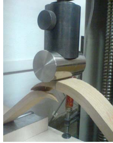
Şekil 3. Deney örneklerine uygulanan diyagonal çekme deneyi
