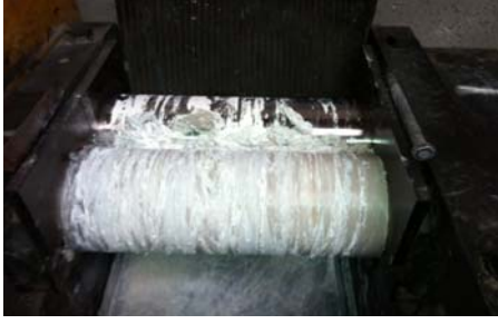
Şekil 1. Kauçuk hamurunun açık millerde hazırlanışı
