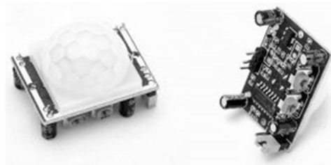
Şekil 2. HC-SR501 PIR sensörü
