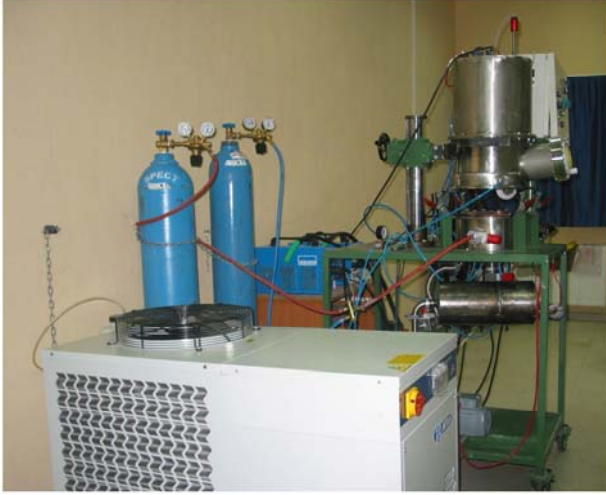
Şekil 1. Vakum ark ergitme cihazı
