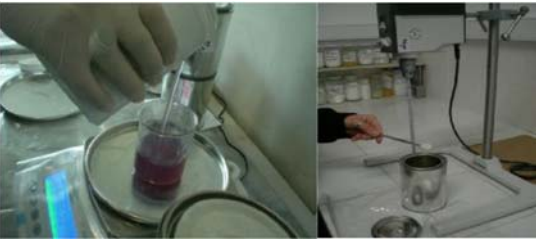
Şekil 2. Polyester ve dolgu maddesinin karıştırılması
