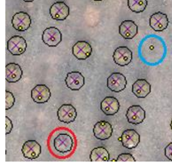
Şekil 15. Tampon alanın (siyah daire) dışında kalan ve ağaç olmayan alanda tespit edilen lokal maksimum nokta mavi renkli daire ile, görüntüde yer alan ancak tespit edilemeyen ağaç ise kırmızı renkli daire ile gösterilmektedir.
