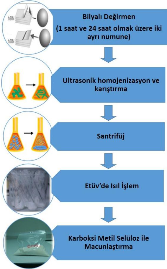
Şekil 3. h-BN tabakalarını ayrıştırma işlemini gösteren akış şeması.
