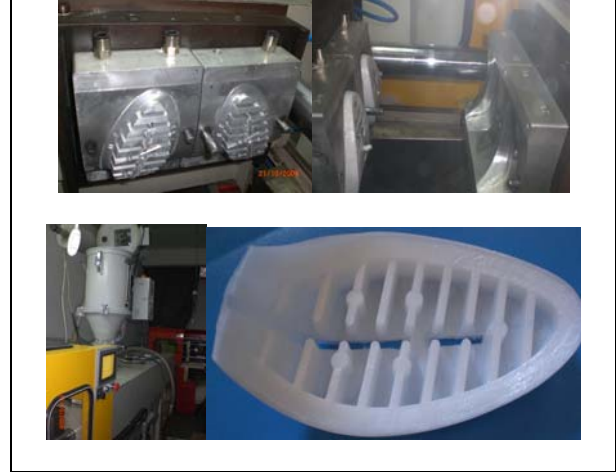
Şekil 1. EVA/AYPE polimer karışımı köpük üretiminde kullanılan kalıp ve enjeksiyon makinesi ve köpüklendirilmiş ürün
