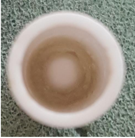
Şekil 1. Hazırlanan toz karışımlarının alümina kroze içerisinde 1550 °C'de ergitilerek sonrasında ani soğutma ile elde edilen cam yapının görüntüsü.
