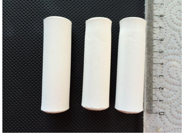
Şekil 2. CIP ile şekillendirme sonrası elde edilen silindir bloklar.
