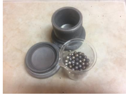
Şekil 2. Deneylerde kullanılan WC kavanozu ve WC bilyaları.
