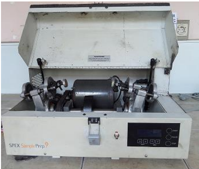
Şekil 1. Deneylerde kullanılan yüksek enerjili bilyalı öğütücü (Spex™ 8000D).
