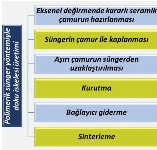
Şekil 1. Polimerik sünger yöntemiyle doku iskelesi üretimi akım şeması.
