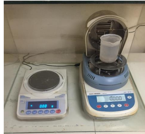
Şekil 3. Arşimet Metoduyla pişmiş çubukların mukavemet ölçüm düzeneği
