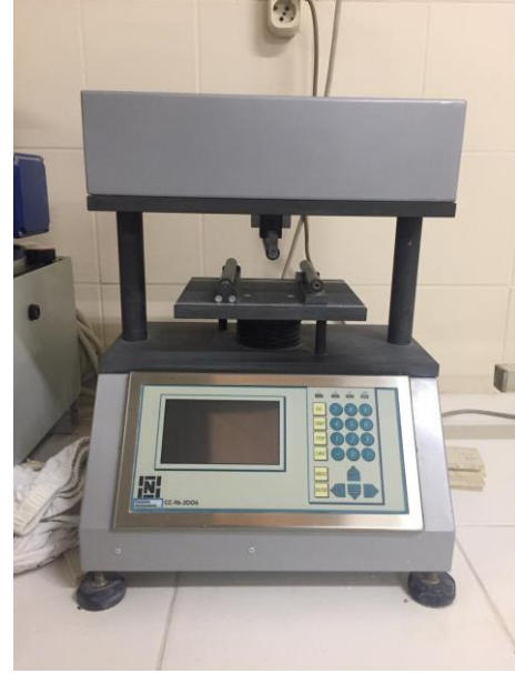
Şekil 2. Fırın tecrübesinden sonra numunelerin mukavemetlerinin ölçüldüğü üç nokta mukavemet ölçüm cihazı
