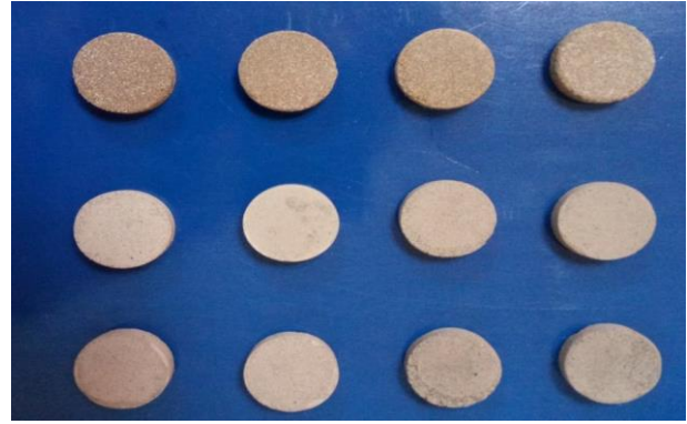
Şekil 1. Sinterlenen numunelerin makro görüntüleri (soldan sağa bileşim oranları azalırken yukarıdan aşağıya sıcaklık miktarları azalmaktadır.)
