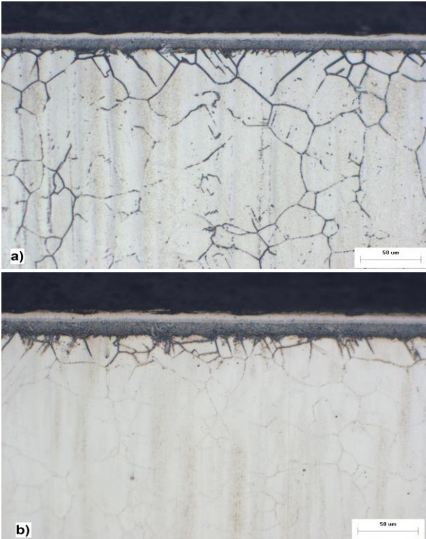
Şekil 2. 4 Saat Süre ile Borlanmış 904 L Süper Östenitik Çeliğin Tabaka Kalınlığı.
