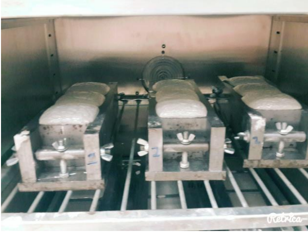
Şekil 2. Numunelerin etüv içerisinde kabarması
