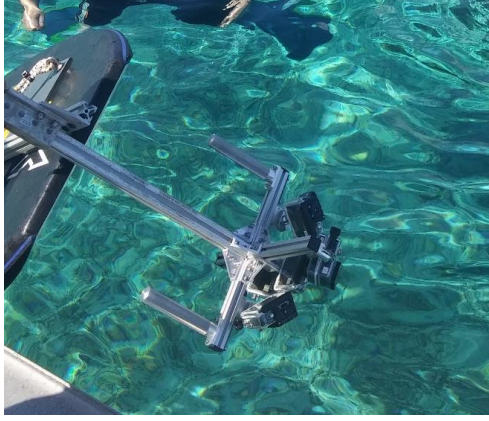
Şekil 4. 5 adet GoPro kamerasından oluşan sualtı kamera sistemi.
