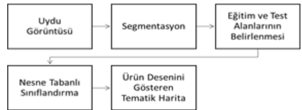
Şekil 2. Nesne tabanlı sınıflandırma işlem adımları
