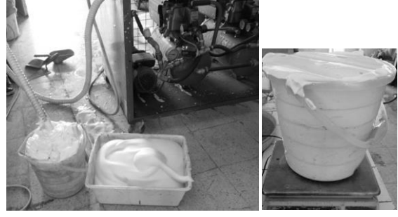
Şekil 3. Köpük üretimi ve yoğunluk kontrolü.
