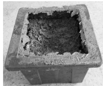
Şekil 7. Uygun olmayan kıvamlardaki örneklerde segregasyon gelişimi.
