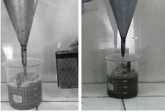
Şekil 6. Düzenli akış (sol), kesikli akış (sağ).
